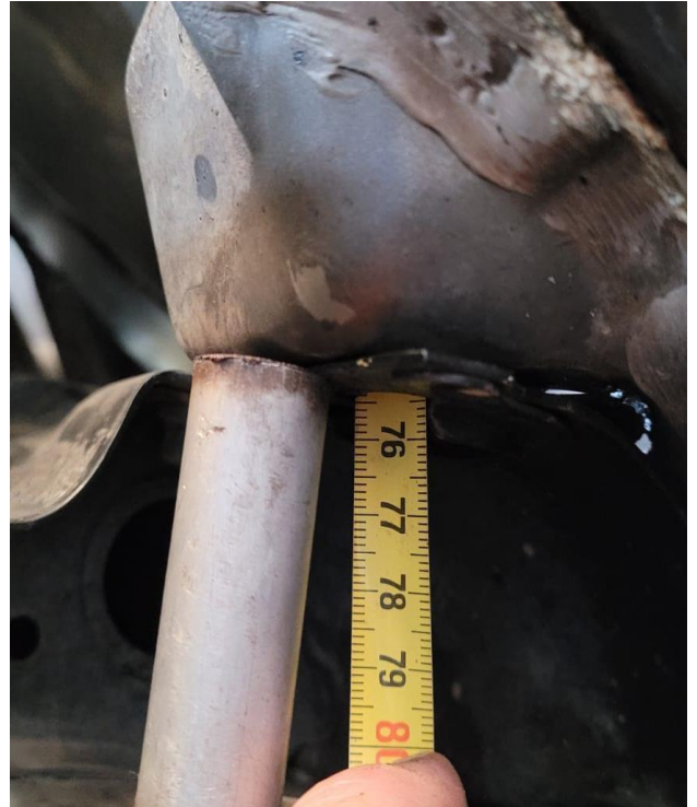
Referencia pestaña interna parallamas y orificio superior para el bulón de parrilla
