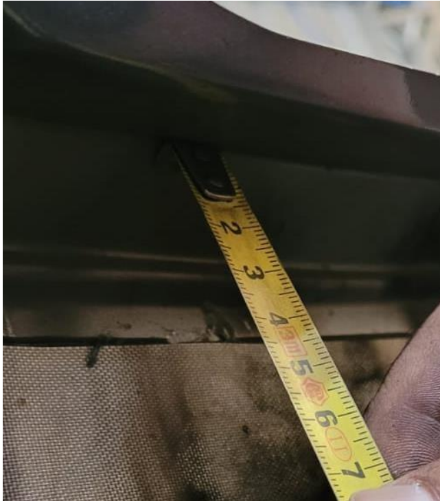
Referencia pestaña interna parallamas y orificio superior para el bulón de parrilla
